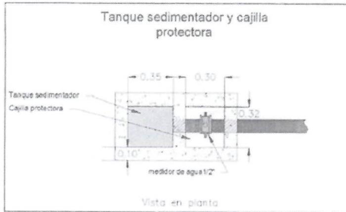
Figura 1. Vista en planta del tanque sedimentador y la cajilla protectora del medidor de agua
