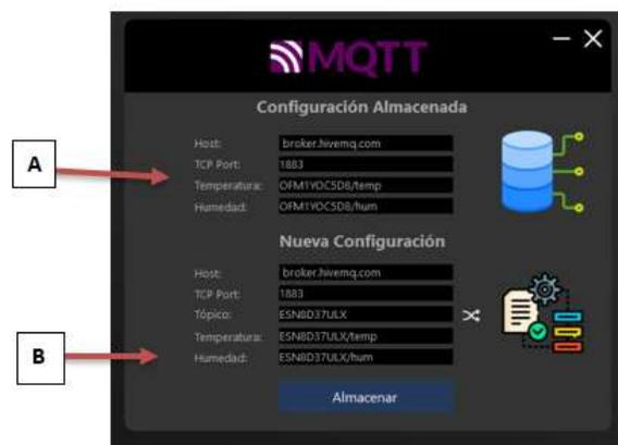
**Figura 7. Bróker. A) Configuración Almacenada:** Este bloque permite visualizar las configuraciones correspondientes a los parámetros de configuración del bróker MQTT, en
