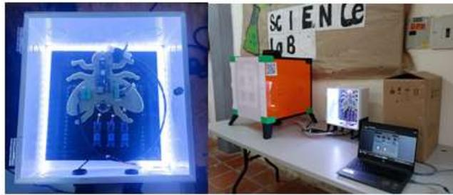
**Figura 6.** Incubadora automatizada, a la izquierda se aprecia la tarjeta controladora con el Arduino nano y los tres módulos de relé. A la derecha la incubadora anclada a la tarjeta controladora y al software de escritorio
