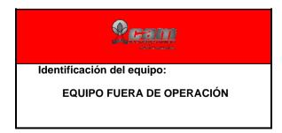
Separar el equipo que se encuentra en condiciones no adecuadas de mantenimiento e identificarlo para evitar su uso. Si el equipo se identificó después de realizar un trabajo, se debe verificar que los resultados no se vean afectados por éste, en caso de encontrarse inconsistencias en los resultados obtenidos se debe seguir el procedimiento PC-GC-06 Control
