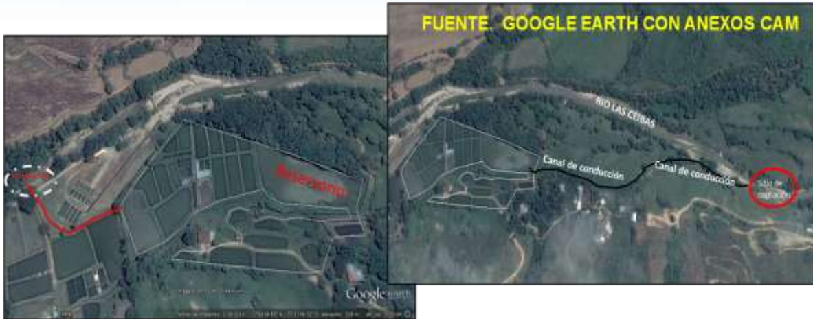
Figuras 30 y 31. Proyectos piscícolas ubicados en la parte media – baja de la cuenca del Río Las Ceibas, que están haciendo mayor derivación de agua a la concesionada, a partir de punto aguas arriba de la bocatoma “El Tomo”. En la imagen se han definido los puntos de captación y de vertimiento.
