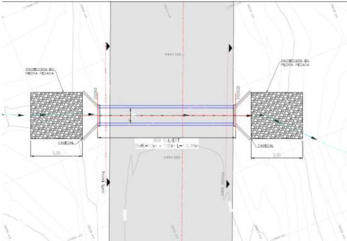
**Figura No. 3.** Esquema de obra Hidráulica Propuesta UF2 – ID-357 abscisa de diseño K44+094.
