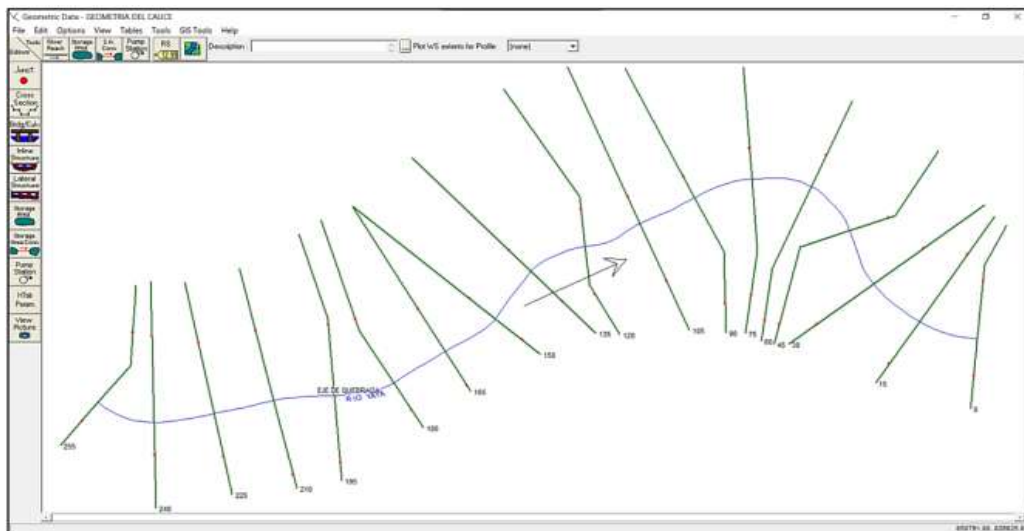
Imagen 3. Figura 9. Esquema en planta de las secciones transversales al cauce en HEC-RAS
