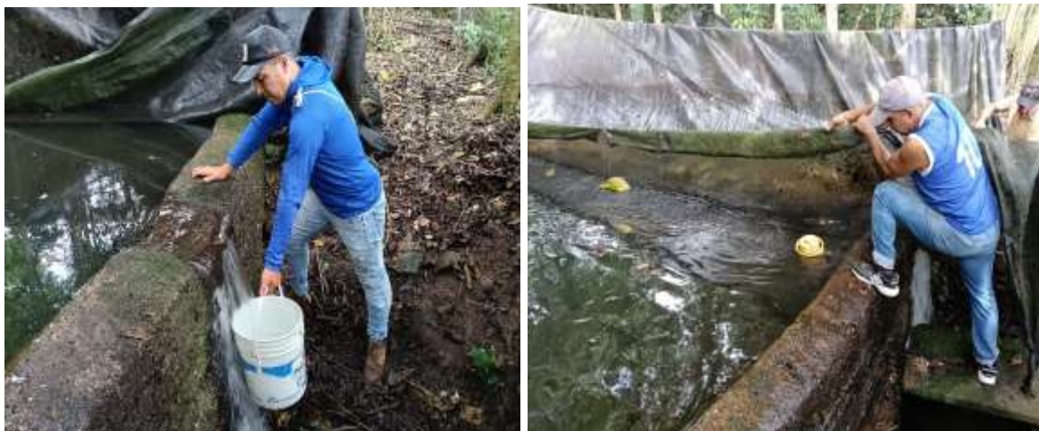
Fotografía 13 y 14 Aforo volumétrico Nacedero quebrada Lindosa, afluyente quebrada Seca.
