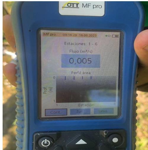
Foto 3 y 4. Aforo y resultado del caudal del Nacimiento de agua El Balso.
