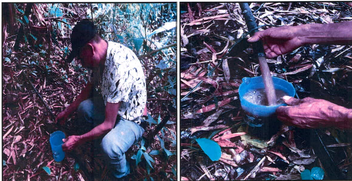
Fotografiar No. 7 y 8: Cálculo de Caudal del drenaje natural sin nombre -vereda Uvital-Pital-Huila
