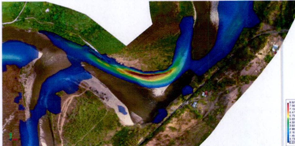
Figura 177 Resultados de erosión con obras - Escenario 3 Fuente: Propia.
