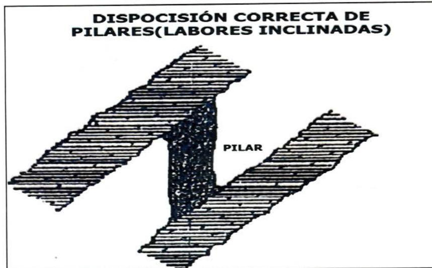
**Imagen 26.** Disposición correcta de pilares (Labores inclinadas).
