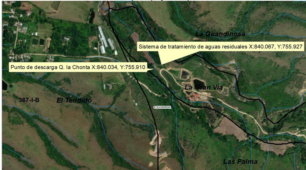
En la imagen se localiza el punto proyectado para el vertimiento sobre la fuente hídrica Q. la chonta en las coordenadas X: 840034, Y: 755.910. y las que ubican el punto del sistema de tratamiento de aguas residuales en las coordenadas X: 840.067, Y: 755.927.
