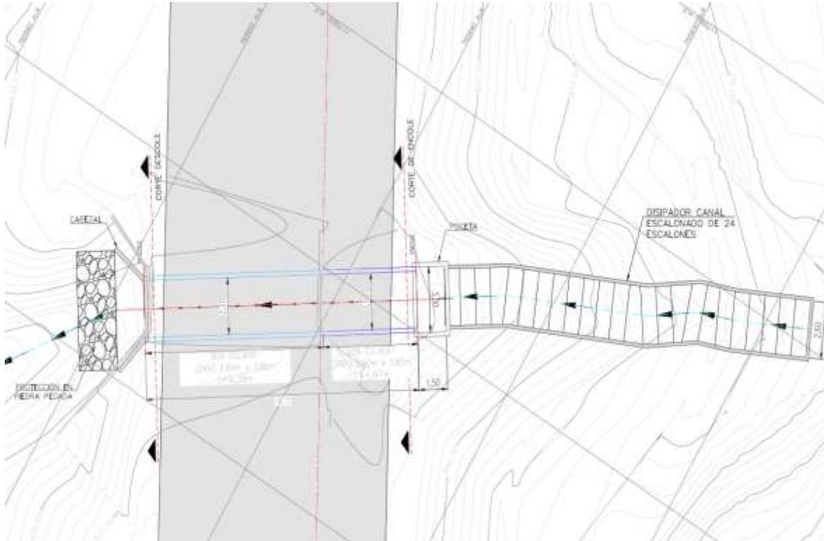
**Figura No. 3.** Esquema de obra Hidráulica Propuesta UF2 – ID-371 abscisa de diseño K42+768.
