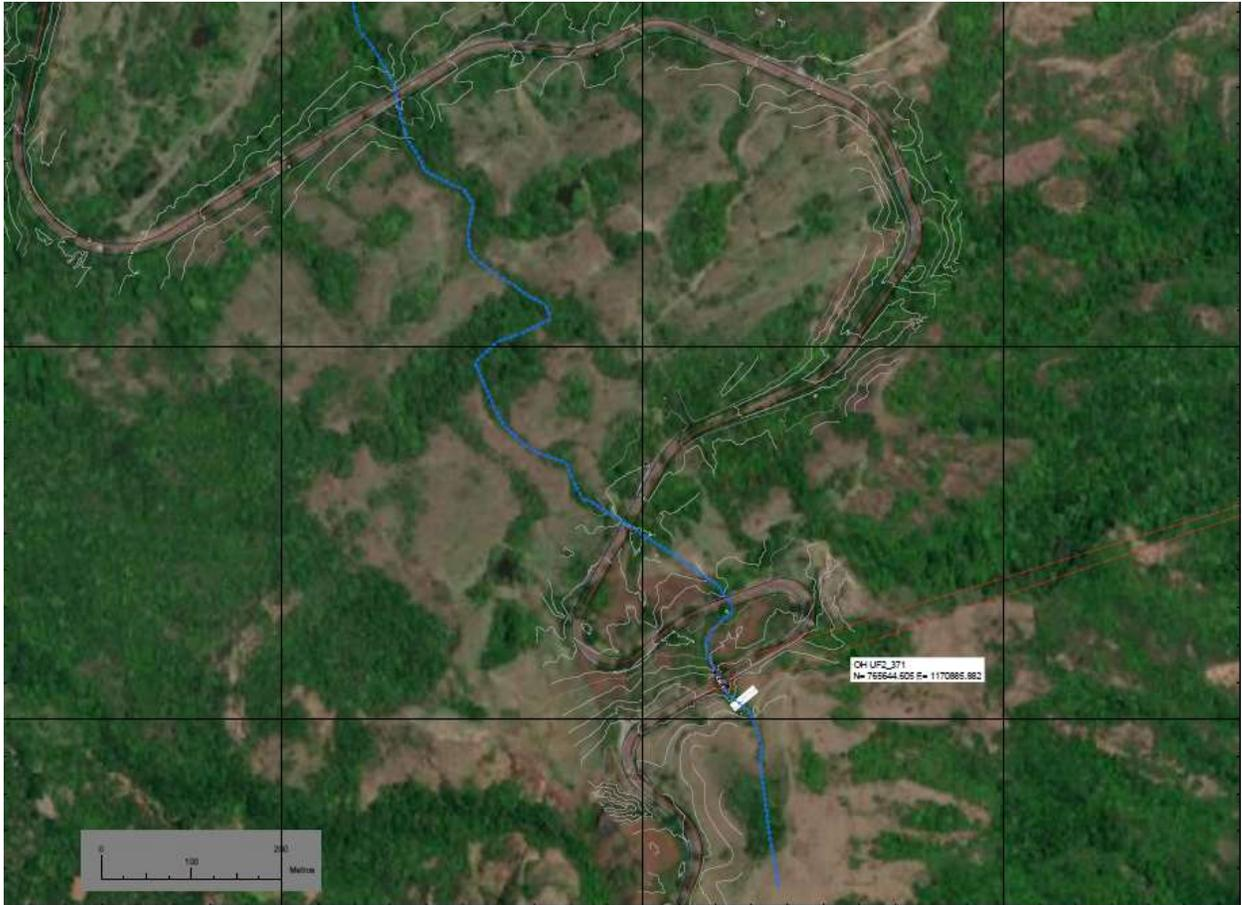
**Figura No. 4.** Mapa de localización del drenaje intervenido obra Hidráulica Propuesta UF2 – ID-371, abscisa de diseño K42+768.
