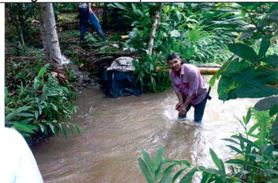
Fotografía 5. Aforo método de flotador al caudal del canal intrapredial
