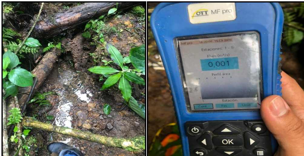
Fotografías 13 y 14: Calculo de caudal de la fuente abastecedora drenaje natural sin nombre.
