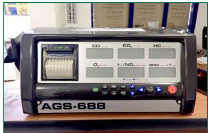
Equipo de medición de contaminantes por fuentes móviles, Banco de gases y Opacímetro
