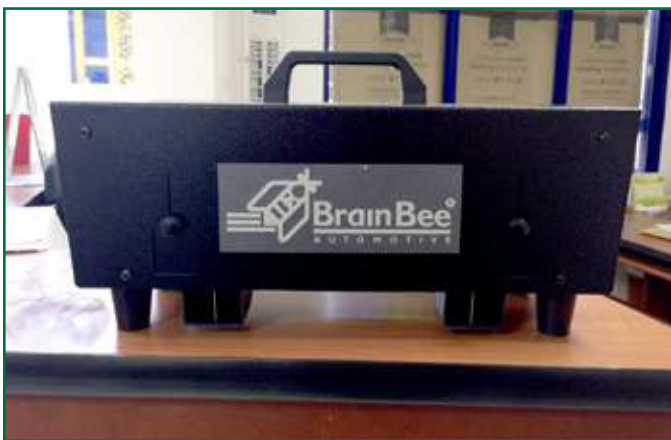
Equipo de medición de contaminantes por fuentes móviles, Banco de gases y Opacímetro
