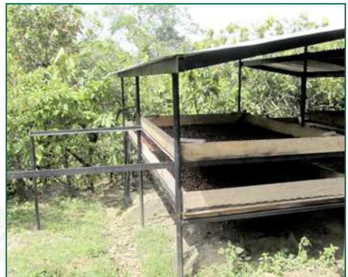
Secadero de cacao con estructura metálica y paseras superiores corredizas. Vereda Floragaita, Neiva.
