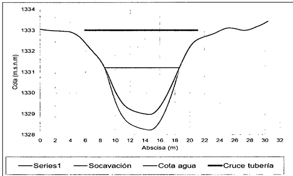
**Imagen 7. Figura** ¡Error! No hay texto con el estilo especificado en el documento.-3. Socavación general en condiciones existentes para la Quebrada La Urraca (K0+190,39)
