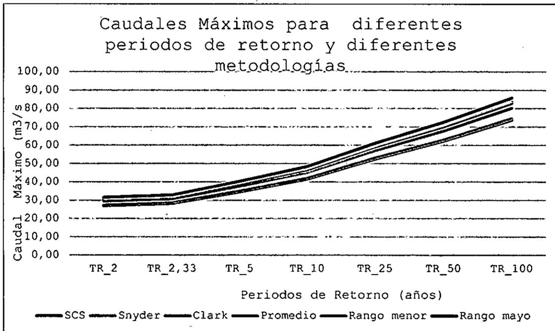
Tabla 5. Figura ¡Error! No hay texto con el estilo especificado en el documento.-2 Variación de caudales máx. vs. Tr condición AMCII (B) – La quebrada La Urraca a la altura de las coordenadas 4.779.988,44927 m Este y 1.891.110,82252 m Norte
