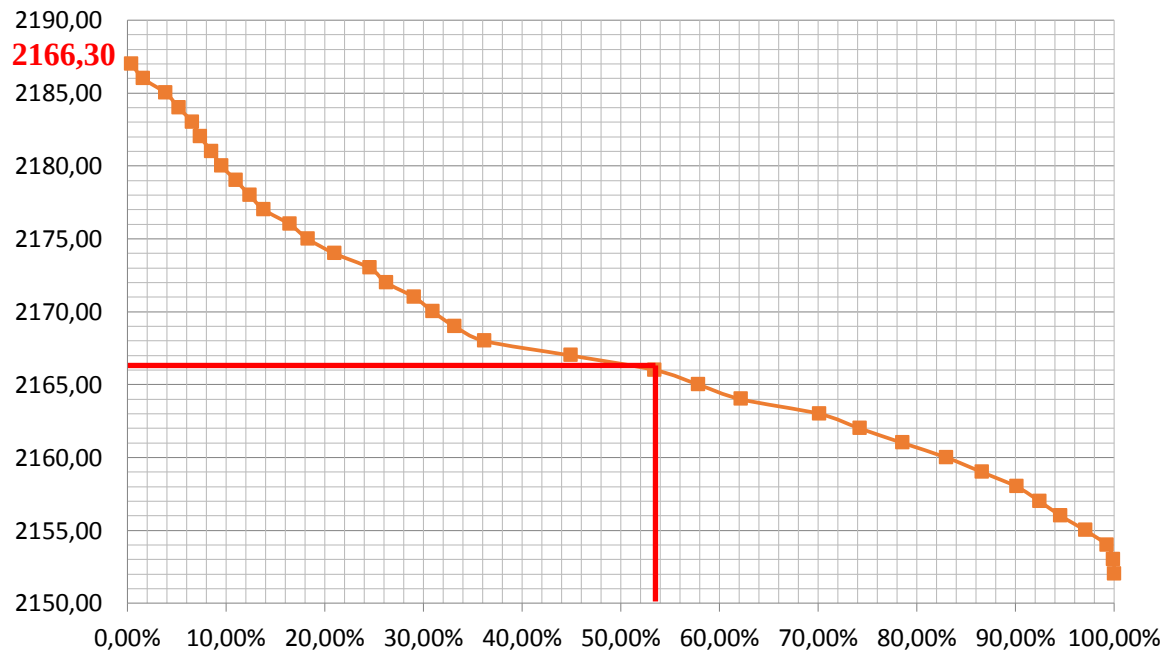
Gráfico 11. Curva hipsométrica. Cota Vs. Porcentaje de distribución de área
