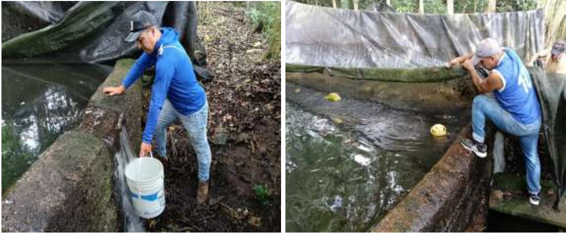
Fotografía 9 y 10 Aforo volumétrico Nacedero quebrada Lindosa, afluente quebrada Seca.
