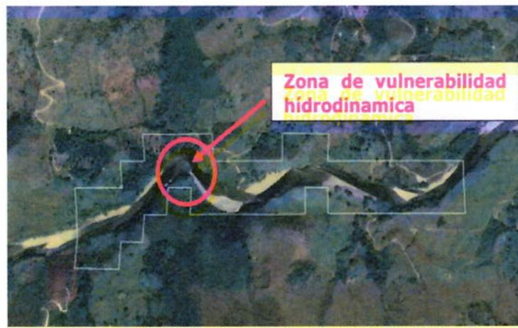
**Imagen 11.** Zona de socavación identificada
