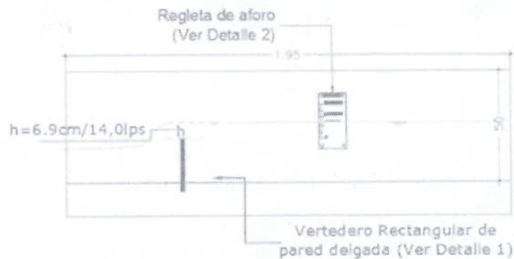
Figura 8 Obra de control corte A-A'
