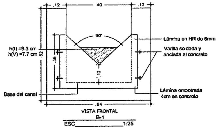
Imagen 9. Diseño Vertedero triangular de pared delgada
