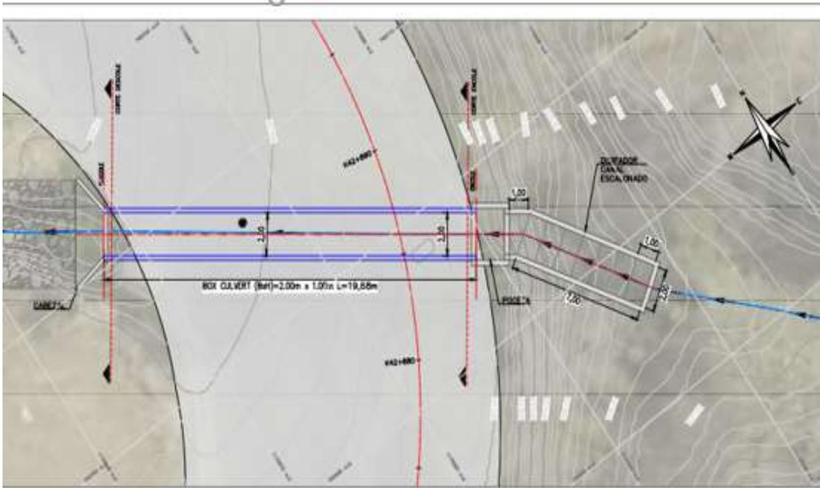
**Figura No. 3.** Esquema de obra Hidráulica Propuesta UF2 – ID-370 abscisa de diseño K42+884
