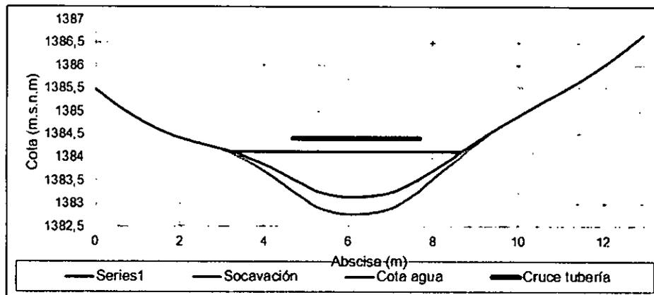
Imagen 9. Figura 7-1. Socavación general en condiciones existentes para El Quebrada Medio Oriente (K0+149,72)
