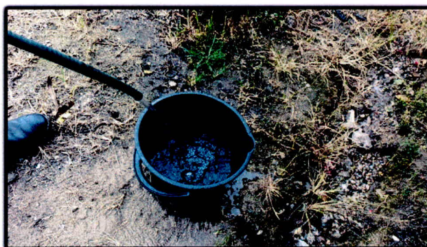
Fotografía No. 7: Aforo por método volumétrico en la casa de un usuario
