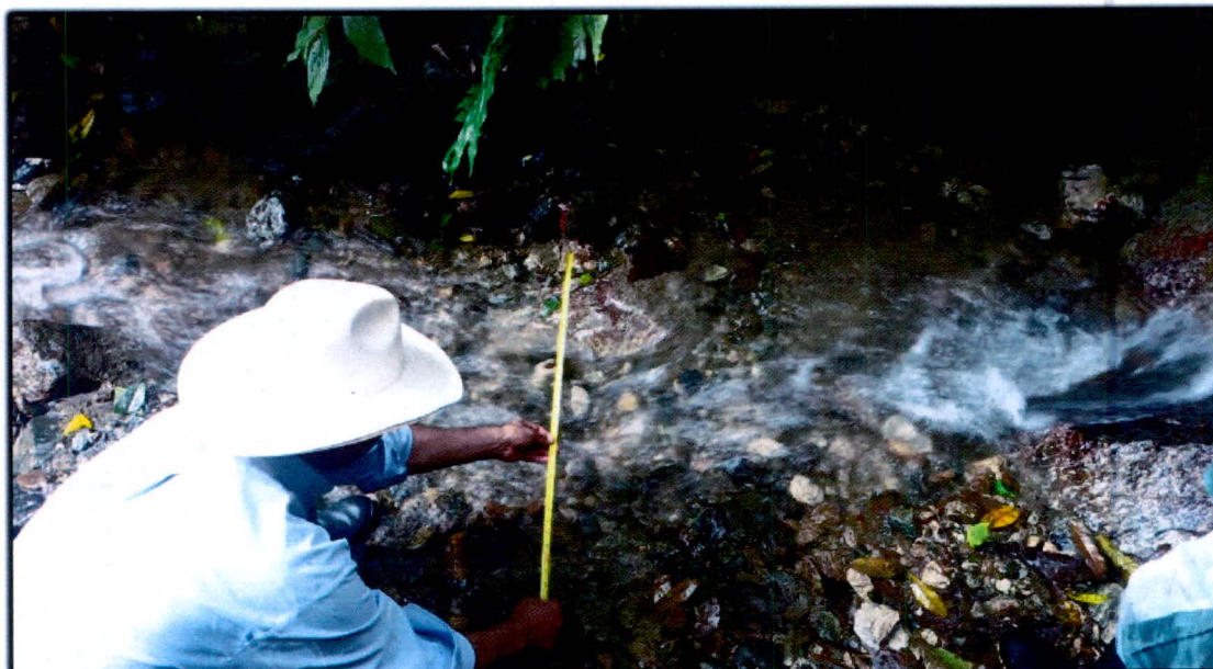
Fotografía No. 6: Aforo por método flotante en el zanjón López
