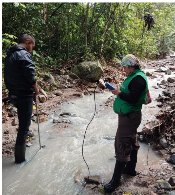
Fotografía No. 4. Aforo antes del punto de captación
