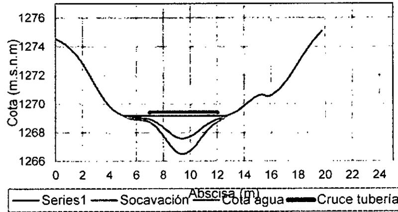
Imagen 8. Figura 7-1. Socavación general en condiciones existentes para la Quebrada Medio Oriente (K0+088,95)
