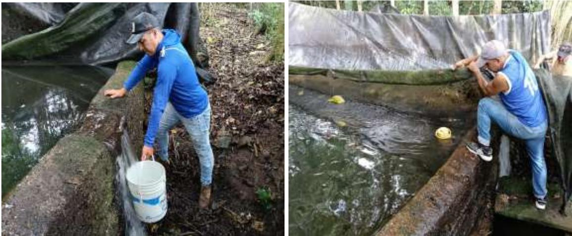
**Fotografía 12 y 13 Aforo volumétrico Nacedero quebrada Lindosa, afluyente quebrada Seca.**
