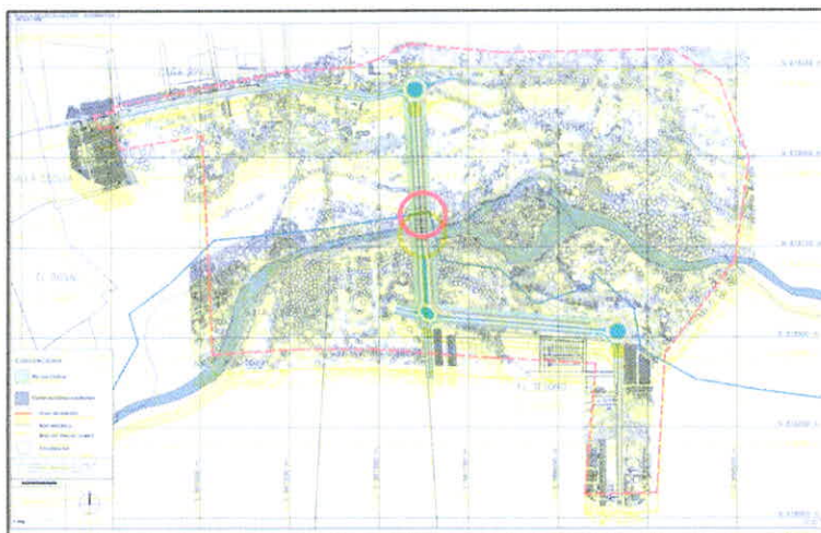
Imagen 48. Interferencia de la red de acueducto de 14" con la alternativa 2 Fuente: DAA, presentado 2026
