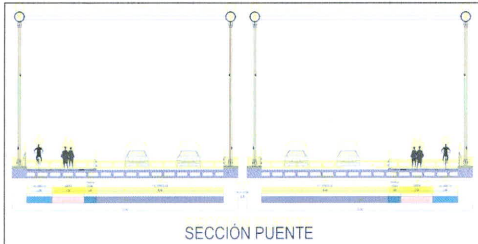
Imagen 8. Sección transversal para dos (2) puentes uno en cada calzada Fuente: DAA, presentado 2026
