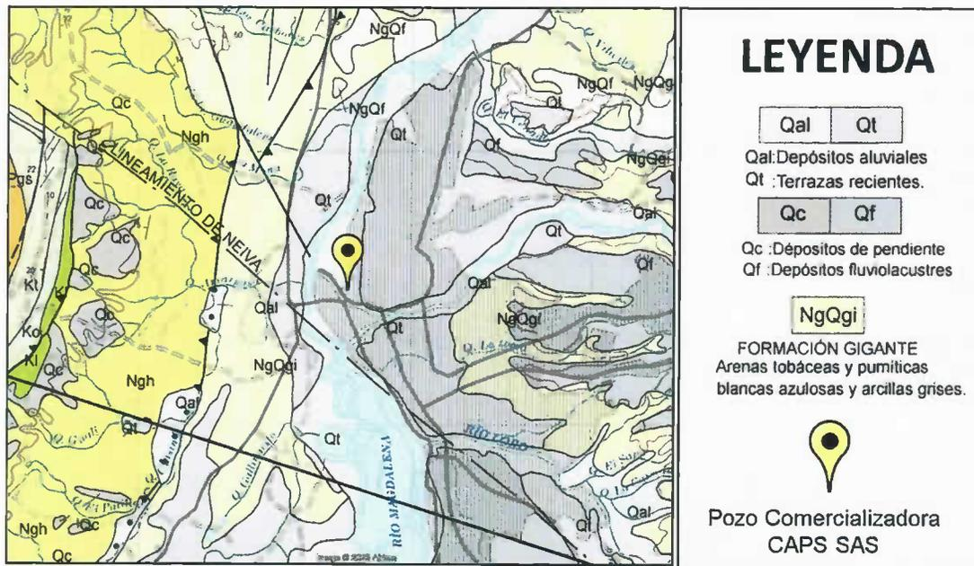
**Imagen 3.** fragmento de la plancha 323 - Neiva elaborada por INGEOMINAS en el año 1998 a escala 1:100.000. El ícono amarillo indica la ubicación del punto de captación. Se evidencia que el pozo se encuentra, de manera superficial sobre terrazas aluviales (Qt), sin embargo, en profundidad corresponde a la Formación Gigante (NgQgi). **Fuente:** INGEOMINAS (Hoy Servicio Geológico Colombiano).
